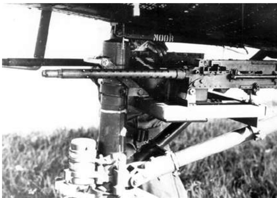
*Vue de l'implantation des mitrailleuses de 0.30 sur le train avant des H-21 pendant l'expérimentation d'avril 1958 (photo X, via Emmanuel Bosc).*
