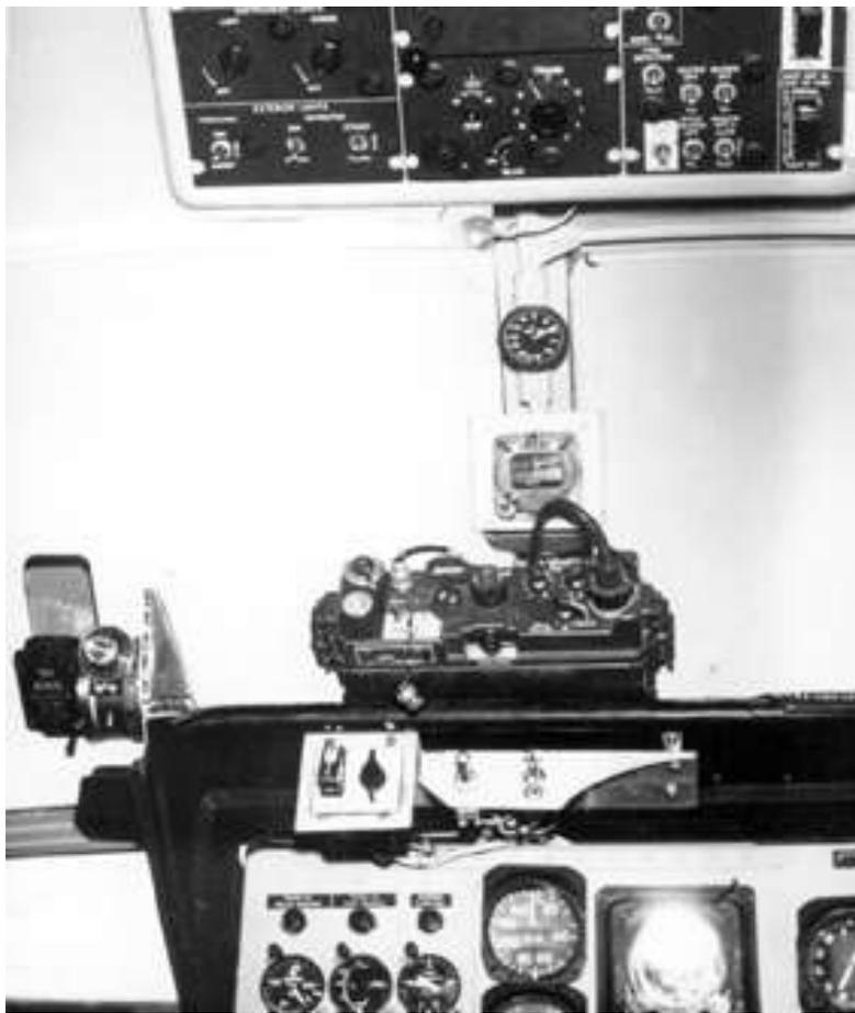
*La planche de bord d'un H-21 armé montrant le collimateur installé à gauche de la planche de bord ainsi que les interrupteurs spécifiques à cet usage installés sous le poste radio HF de communication avec les troupes au sol (photo X, via E. Bosc).*
