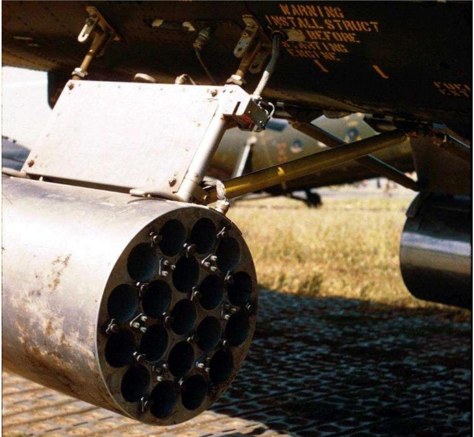
*Vue rapprochée montrant le montage définitif des paniers MATRA 116 à 19 alvéoles de 68 mm.
